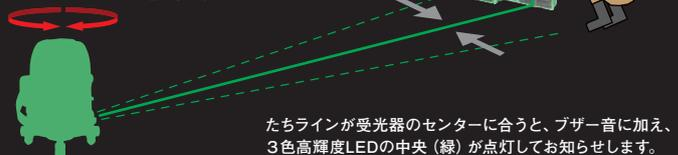
たち線が受光器のセンターに合うと、プザー音に加え、3色高輝度LEDの中央(緑)が点灯してお知らせします。
