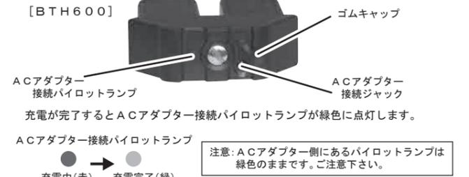
ポイント:充電電池のフル充電は4~5時間ですが、最初に充電する時、約7時間充電するとその後の充電容量が増します。初回のみ7時間程充電して下さい。充電中でも本機を使用することが出来ます。
