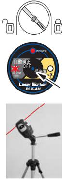
右図のようにジnPバロックツマミがOFF側の状態のまま、操作パネルのモード切替ボタンを押します。電源ランプが点灯、自動補正OFFモードランプが点滅し、レーザーが照射されます。この時、自動補正警告機能(補正外時レーザー点滅及びブザー音)はOFFとなります。
