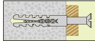
取付物を所定の位置にセットし、木ネジで確実に固定します。
