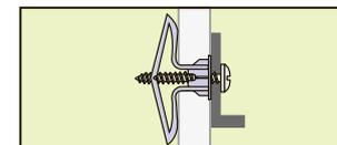
取り付け物をネジで確実に固定します。この時、母材が石膏ボードの場合、あまりきつく締め過ぎないようにしてください。
