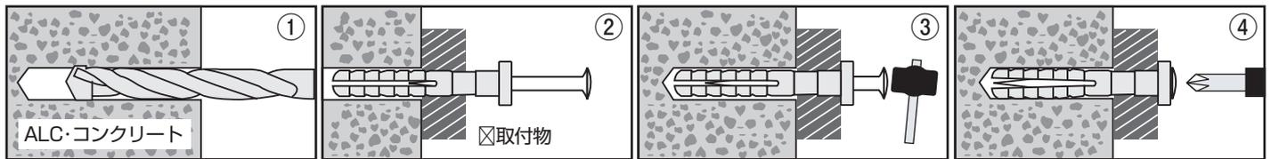
① 使用プラグにあったサイズのドリルで穴をあけてください。穴あけ後、プラグを挿入する前に必ず、孔内の切粉を除去してください。
